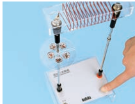
▲電流がつくる磁界の実験 (右ネジの法則)
