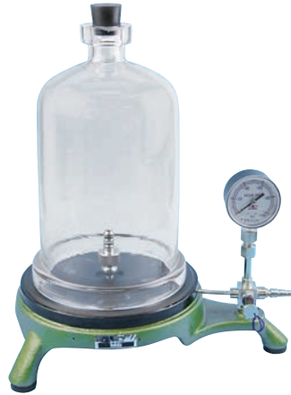
② 排気盤 EV-M
