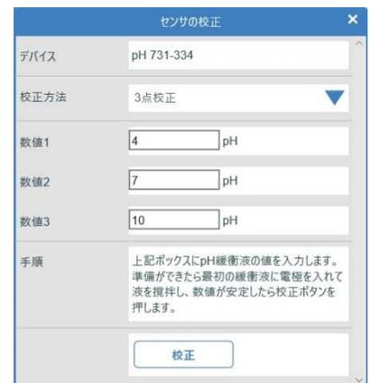
ユーザー校正情報は pH センサアダプタに記録され、再度ユーザー校正を行うまで保存され続けます。
