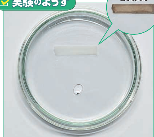
▲フタをしたシャーレの中で、ごく少量の硫化鉄に希塩酸を加えた時のようす
