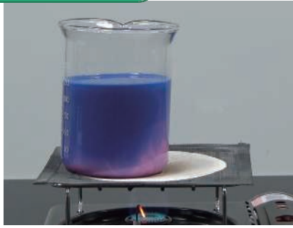
▲示温インク(サーモインク)で水の温まり方を調べる実験
