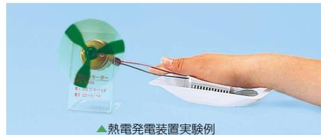
▲熱電発電装置実験例
